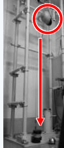
衝撃吸収性試験の様子
